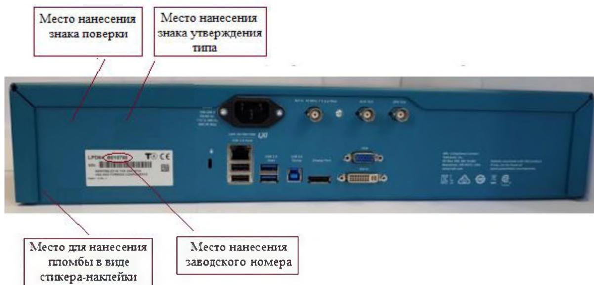
Рисунок 1. Общий вид средства измерений с указанием мест пломбировки (для стикера-наклейки), мест нанесения знака утверждения типа, знака поверки, заводского номера
